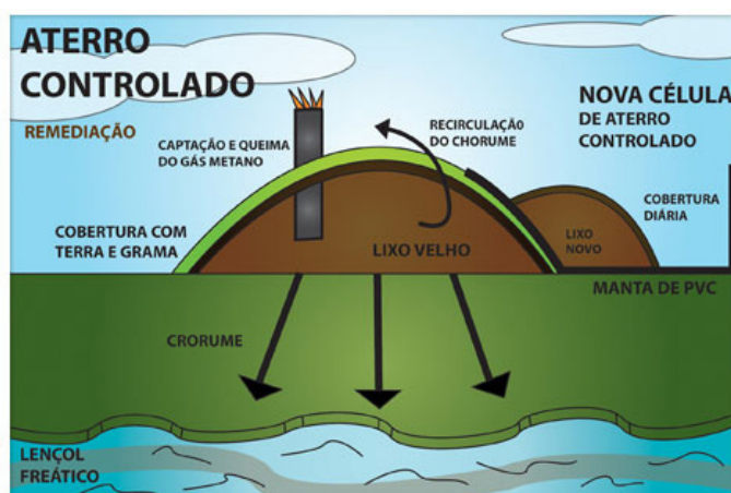
Imagem 35: Esquema de como funciona um aterro controlado. Fonte: Meio Ambiente – Cultura Mix, retirado de http://meioambiente.culturamix.com/gestao-ambiental/aterro-sanitario-suas-definicoes-e-conceitos/ > acesso em 14 fev. 2018.
