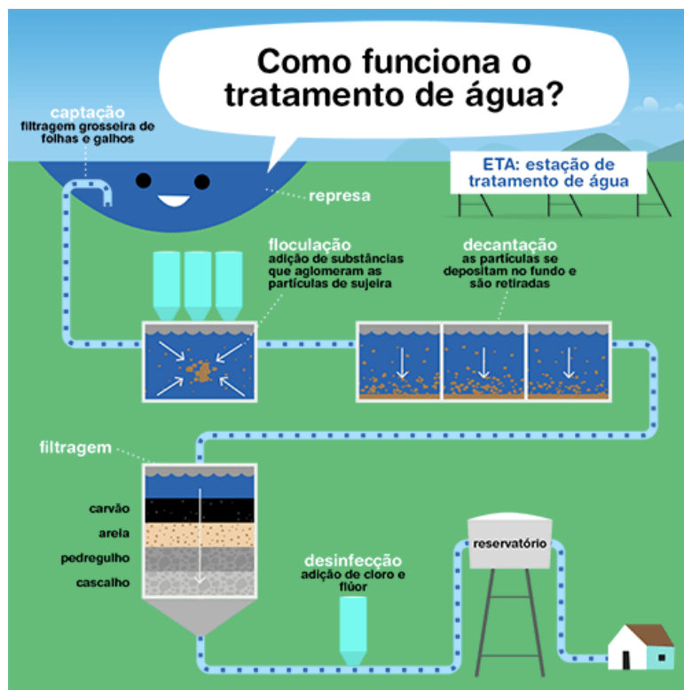
Imagem 10: Como funciona o tratamento de água? Fonte: Água, sua linda, 2018, retirado de < https://agua-sua-linda.tumblr.com/ >, acesso em 15 fev. 2018.
