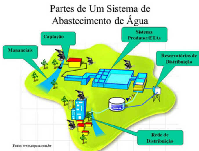
Figura 74: Sistema de Abastecimento de água. Fonte: http://slideplayer.com.br/slide/366587/
