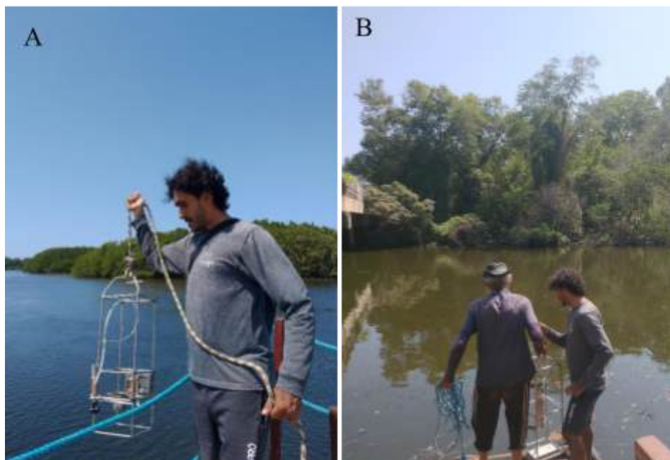
Figura 9 – Instalação dos sensores de pressão. A – Nas proximidades da foz, Sabiaguaba. B – Nas proximidades da área do incêndio, Pôr do Parque do Cocó.
