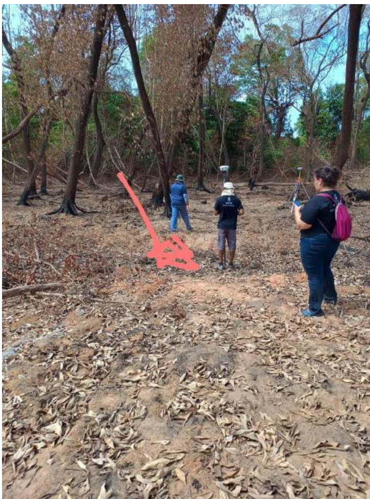
Figura 2 – Utilização do RTK em campo. Vista para as antenas 'base' e 'rover'.
