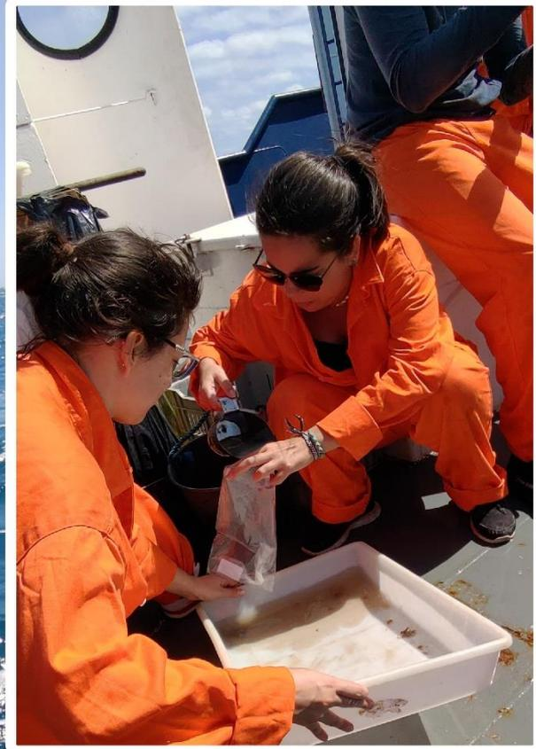
*Figura 12 - - Amostragem de sedimento com a draga Van Veen a bordo da embarcação Argo Equatorial.*
