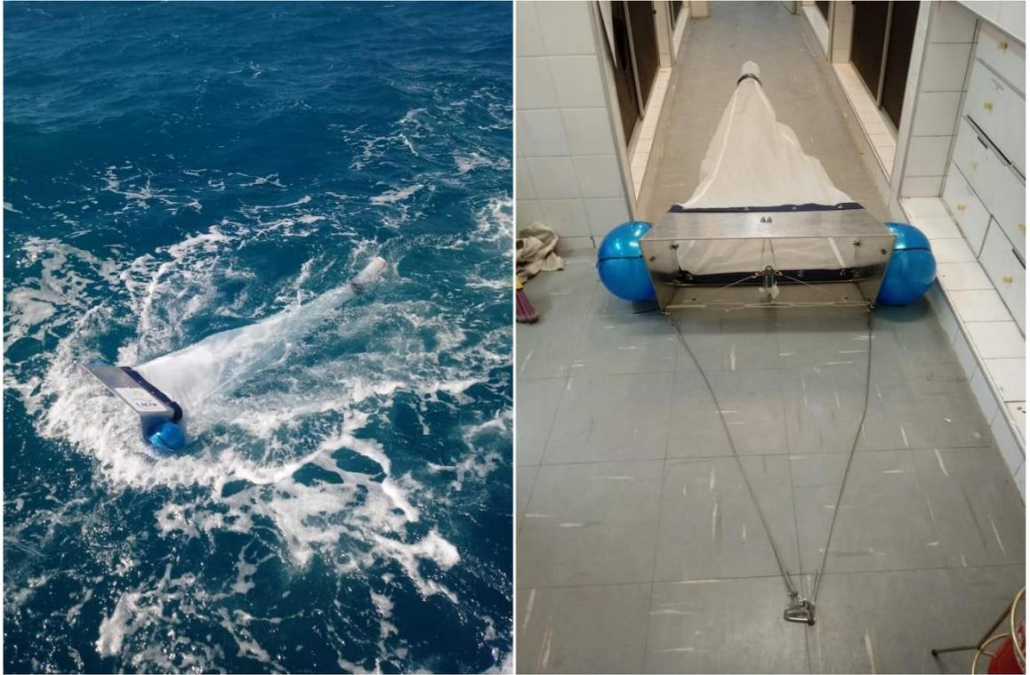
*Figura 13 - Amostrador do tipo rede de Neuston utilizado na amostragem de microplásticos para diagnóstico ambiental do PEMPRIM.*
