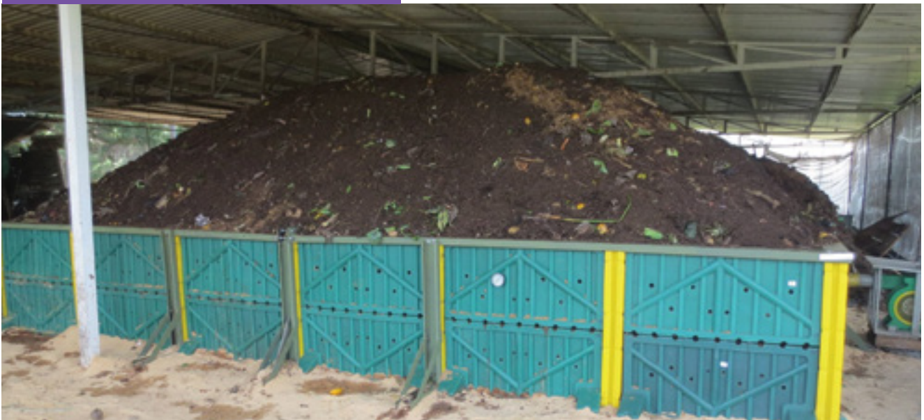
Foto 11 – Pilha Estática de compostagem com aeração forçada.
