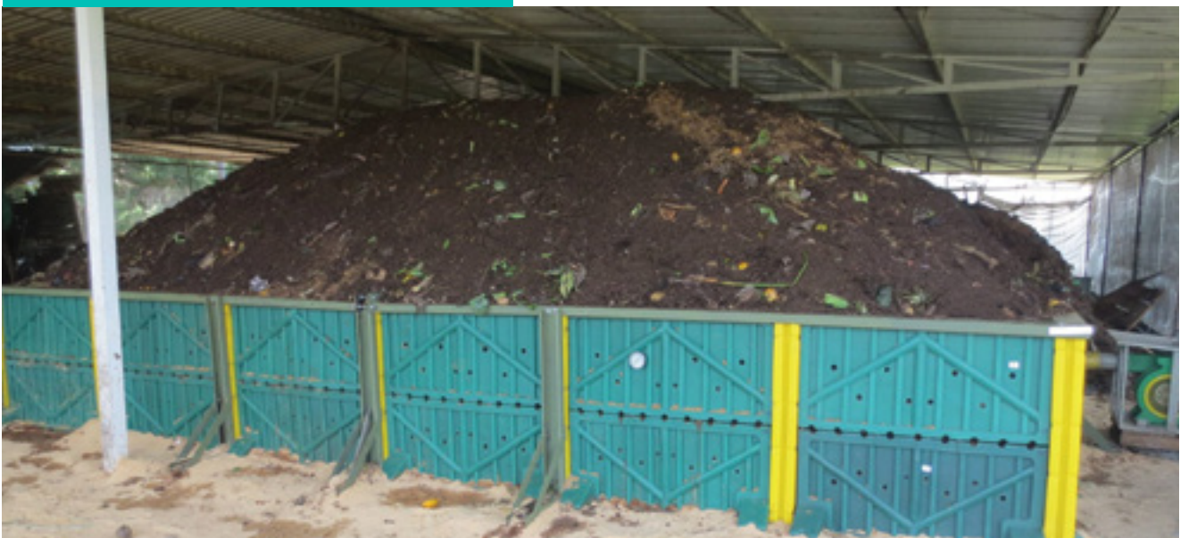
Foto 22 – Pilha Estática de compostagem com aeração forçada.
