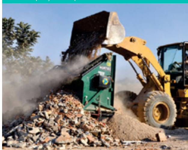
Foto 24 – Operação com a peneira vibratória.
