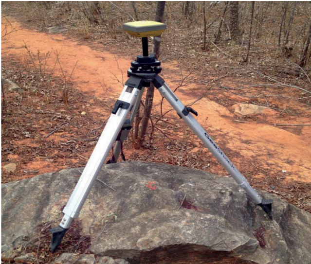
■ Figura 4. A: GPS diferencial Topcon HIPER SR utilizado para o georreferenciamento dos pontos de amarração (PA) do levantamento topográfico da caverna. B: Detalhe do PA DG-007.
