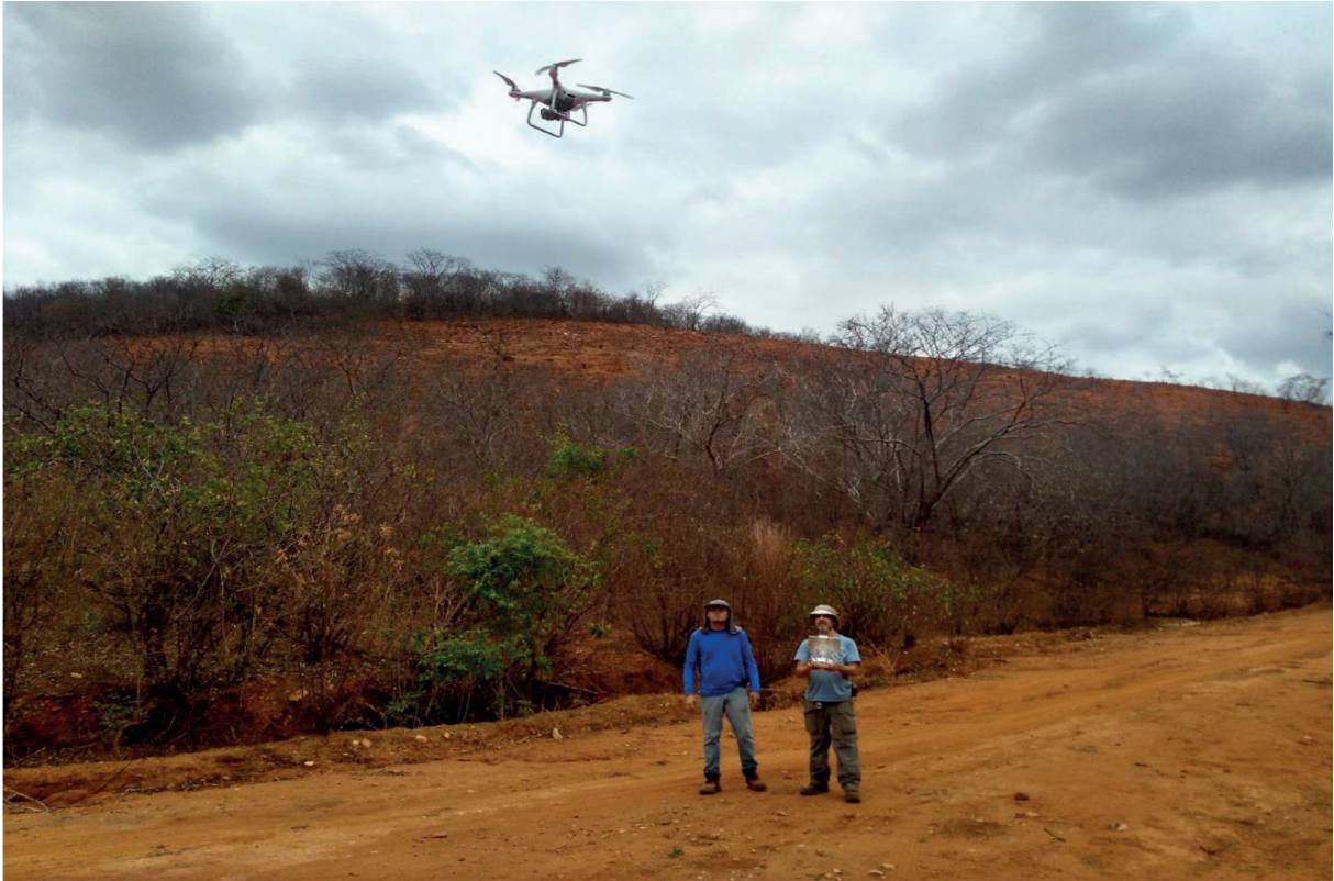
■ Figura 6. Drone Phantom 4 Pro usado para obter imagens aéreas e para gerar modelos digitais do terreno e mapas topográficos da área.
