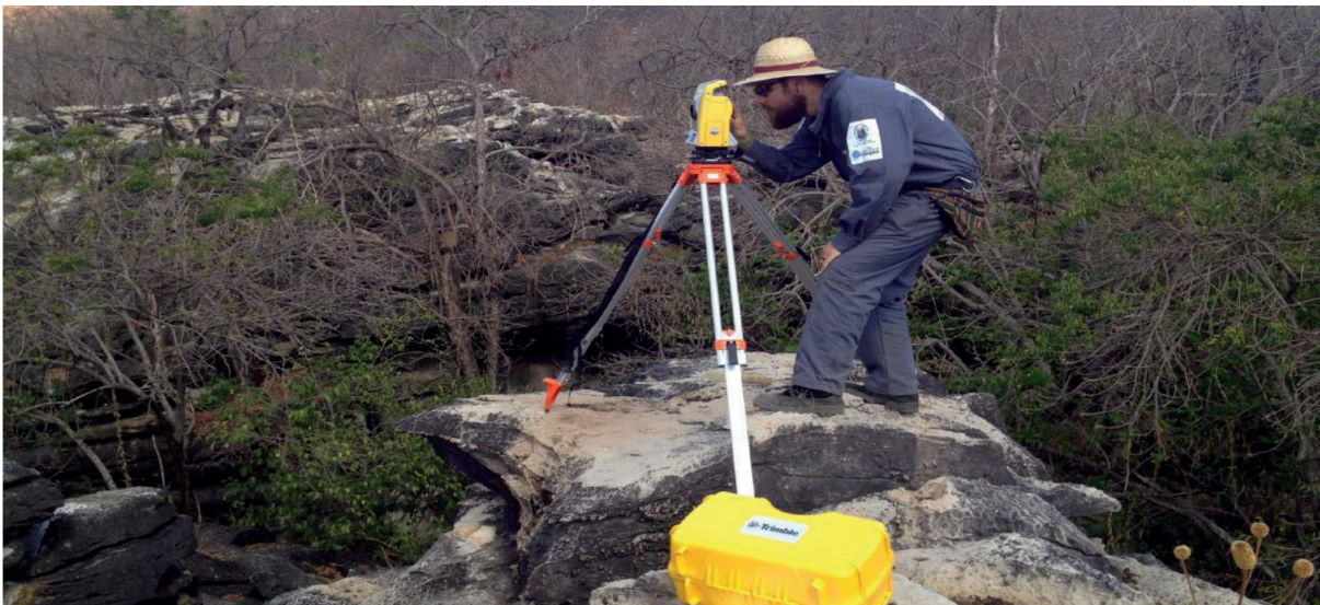
■ Figura 5. Estação total Trimble M3 usada para posicionar estações fixas no interior da caverna e pontos de amarração (PA) para o levantamento topográfico.
