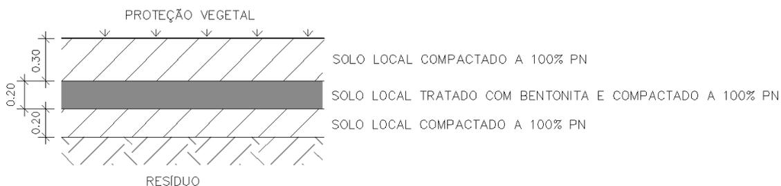
**Figura 5.3** - Detalhe do revestimento de cobertura dos resíduos.
