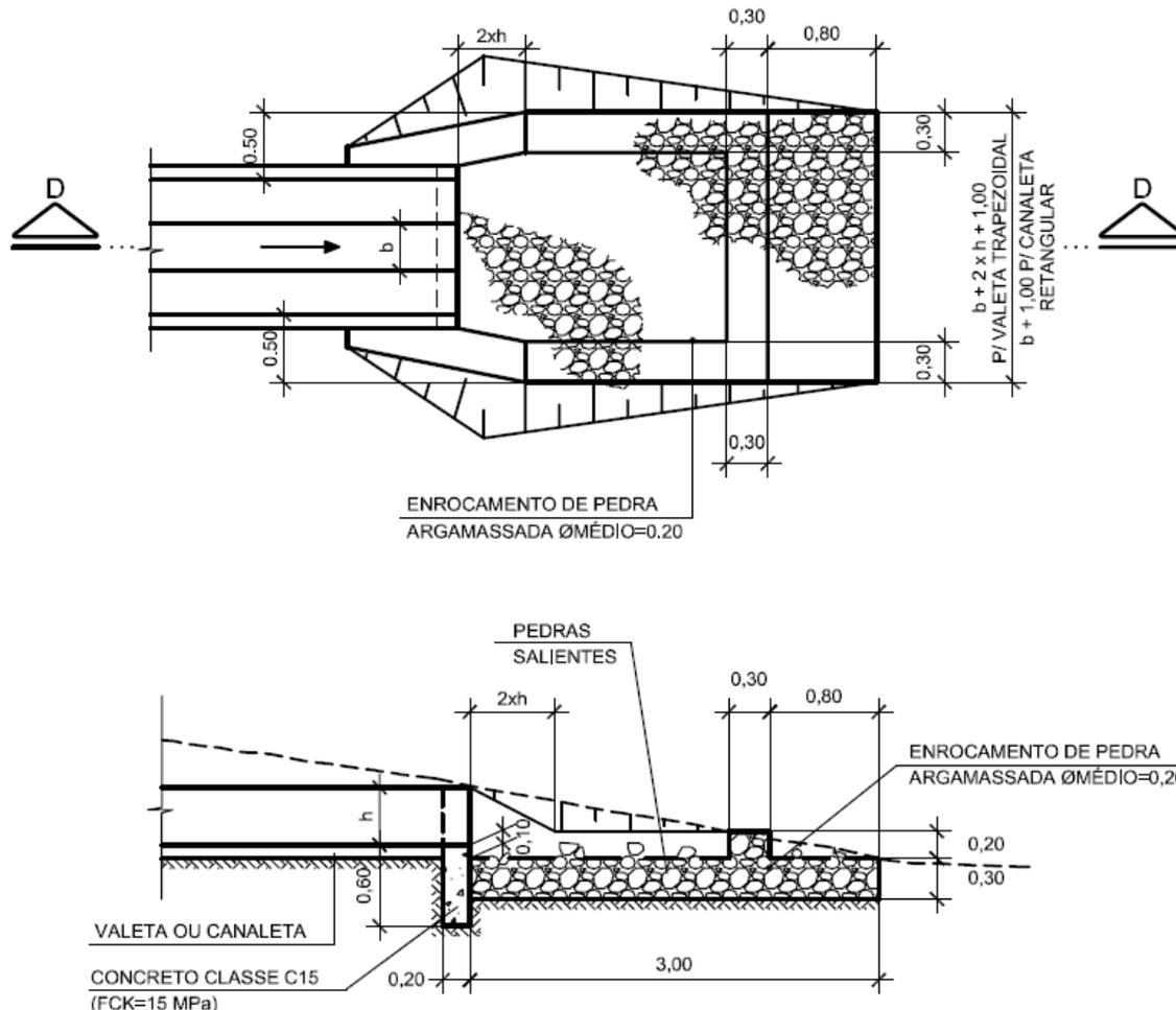
Figura 5.12 - Dispositivo de dissipação padrão DER tipo DR-10A-1.
