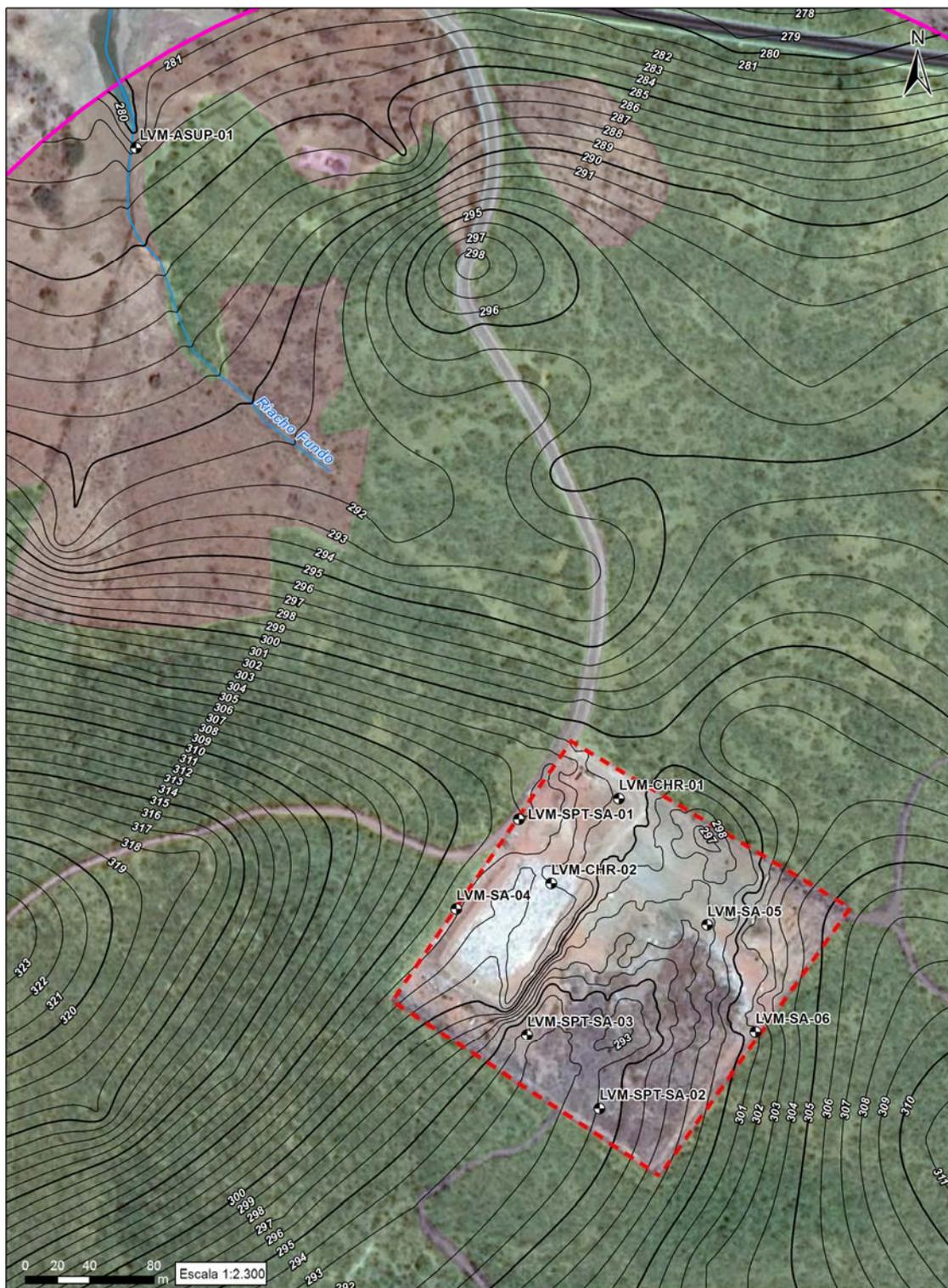
**Figura 4.2** – Detalhe do levantamento planialtimétrico realizado na área do Lixão de Lavras da Mangabeira. Fonte: TÜV SÜD Bureau, 2017-b).
