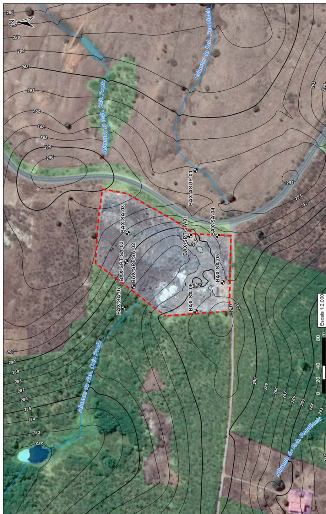
Figura 4.2 – Detalhe do levantamento planialtimétrico realizado na área do Lixão de Baixo. Fonte: TÜV SÜD Bureau, 2017-b.
