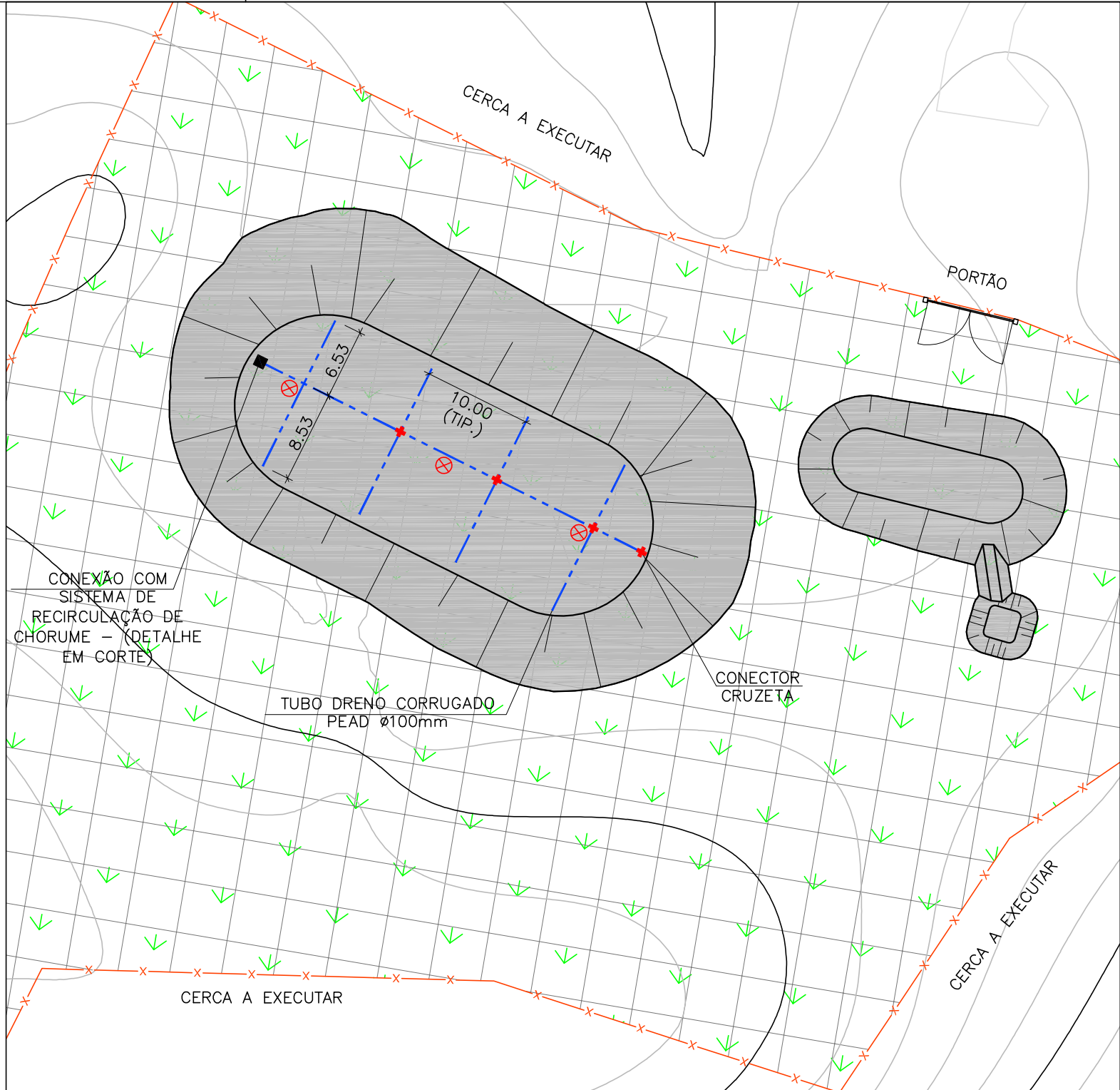
SISTEMA DE RECIRCULAÇÃO DE CHORUME ESC. 1:500 (VER NOTA 7)
