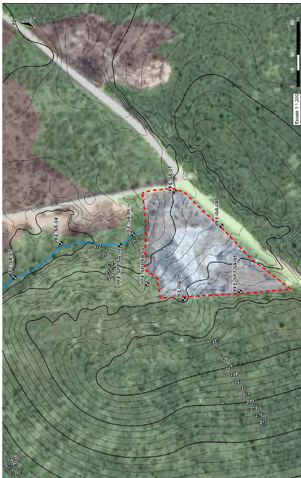
Figura 4.2 – Detalhe do levantamento planialtimétrico realizado na área do Lixão de Pires Ferreira. Fonte: TÜV SÜD Bureau, 2017-b).
