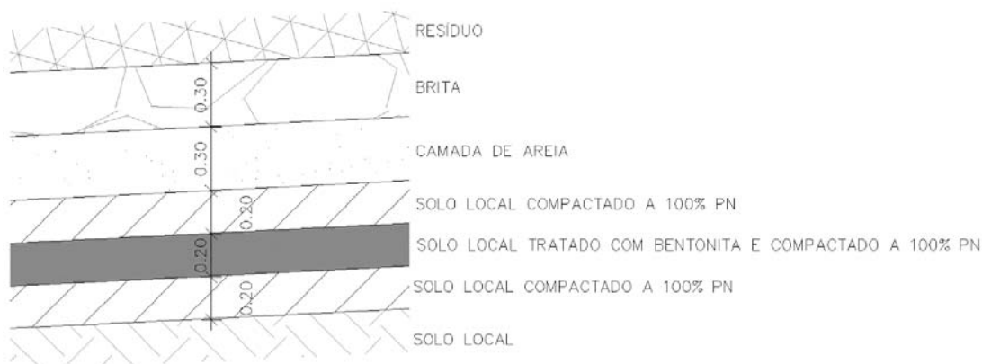
Figura 5.3 - Detalhe das camadas do revestimento de fundo e drenagem de chorume.
