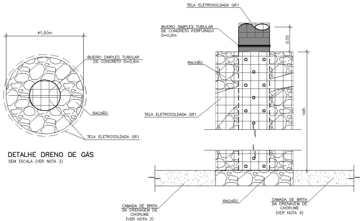
Figura 5.11 - Detalhe dos drenos de gás.
