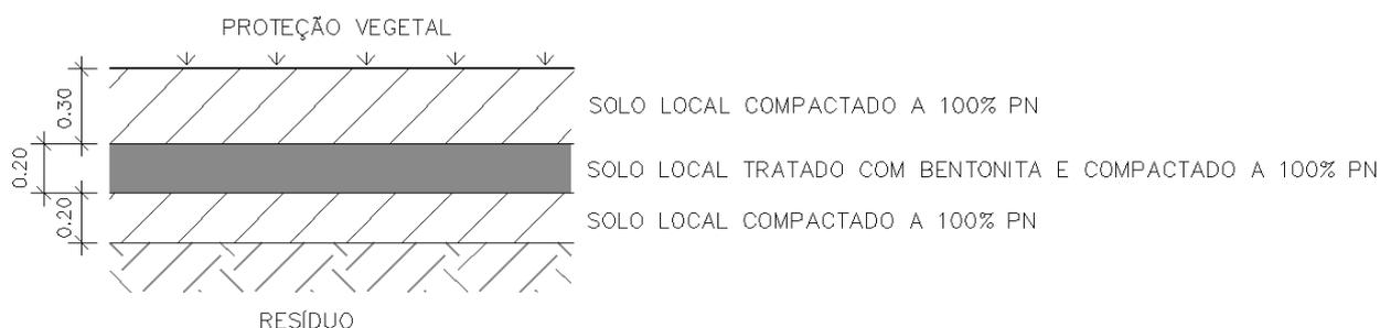
**Figura 5.4** - Detalhe do revestimento de cobertura dos resíduos.
