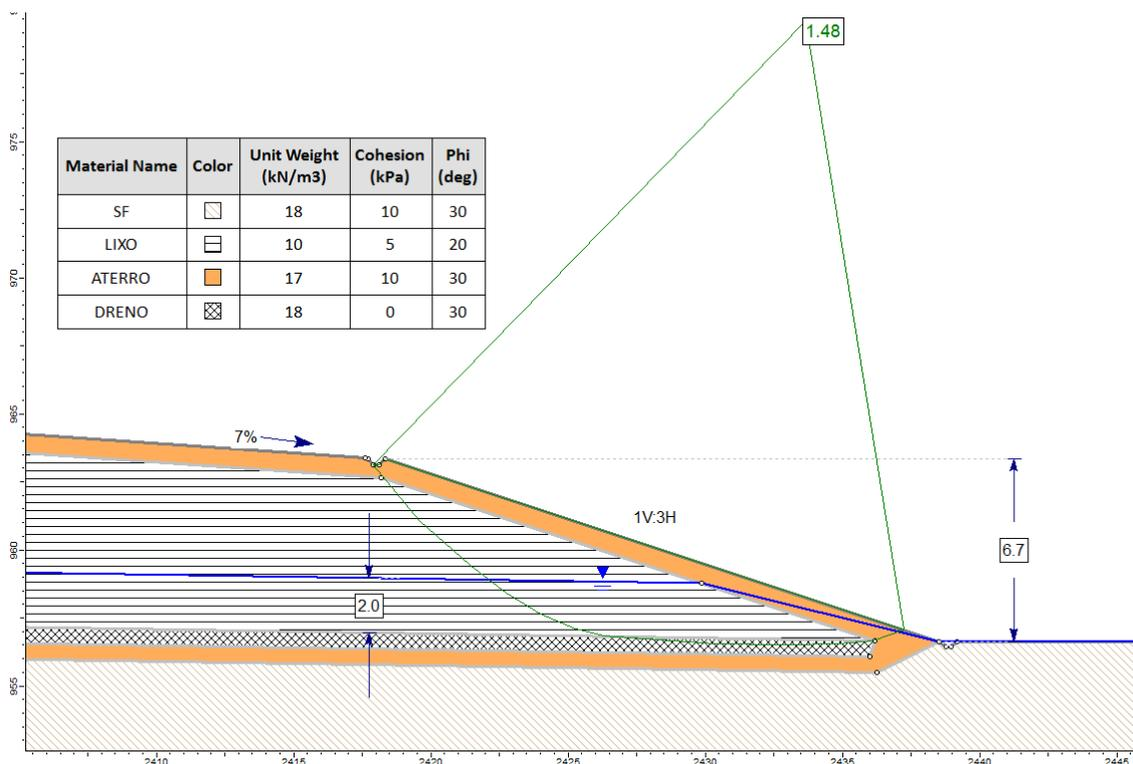
**Figura 5.3** - Saída gráfica da análise de estabilidade da pilha de resíduos com altura máxima de talude de 6,7 m. FS = 1,48.
