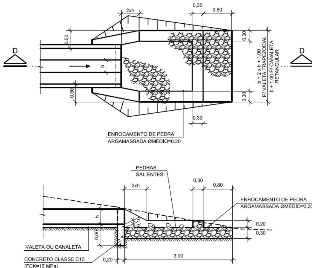
**Figura 5.13** - Dispositivo de dissipação padrão DER tipo DR-10A-1.
