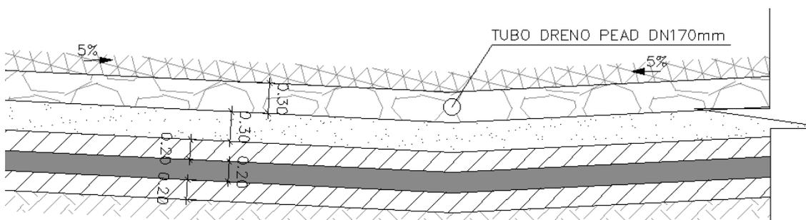
**Figura 5.5** - Detalhe do caimento de fundo e do posicionamento dos tubos drenos.
