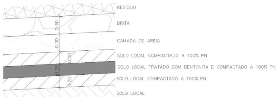
**Figura 5.4** - Detalhe das camadas do revestimento de fundo e drenagem de chorume.
