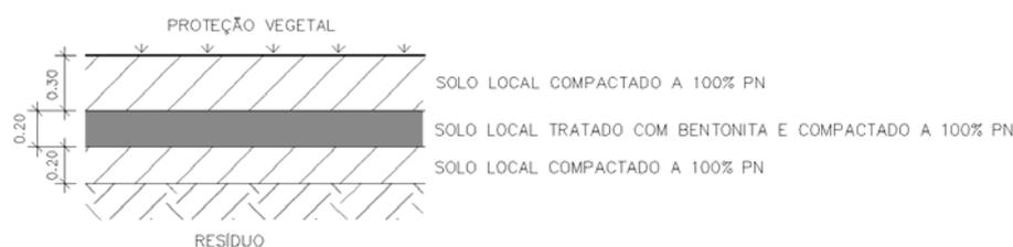
**Figura 5.3** - Detalhe do revestimento de cobertura dos resíduos.
