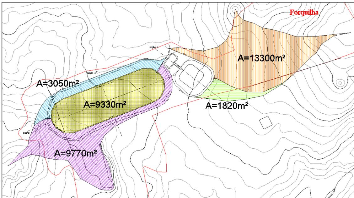
**Figura 5.11** - Áreas de contribuição do sistema de drenagem.
