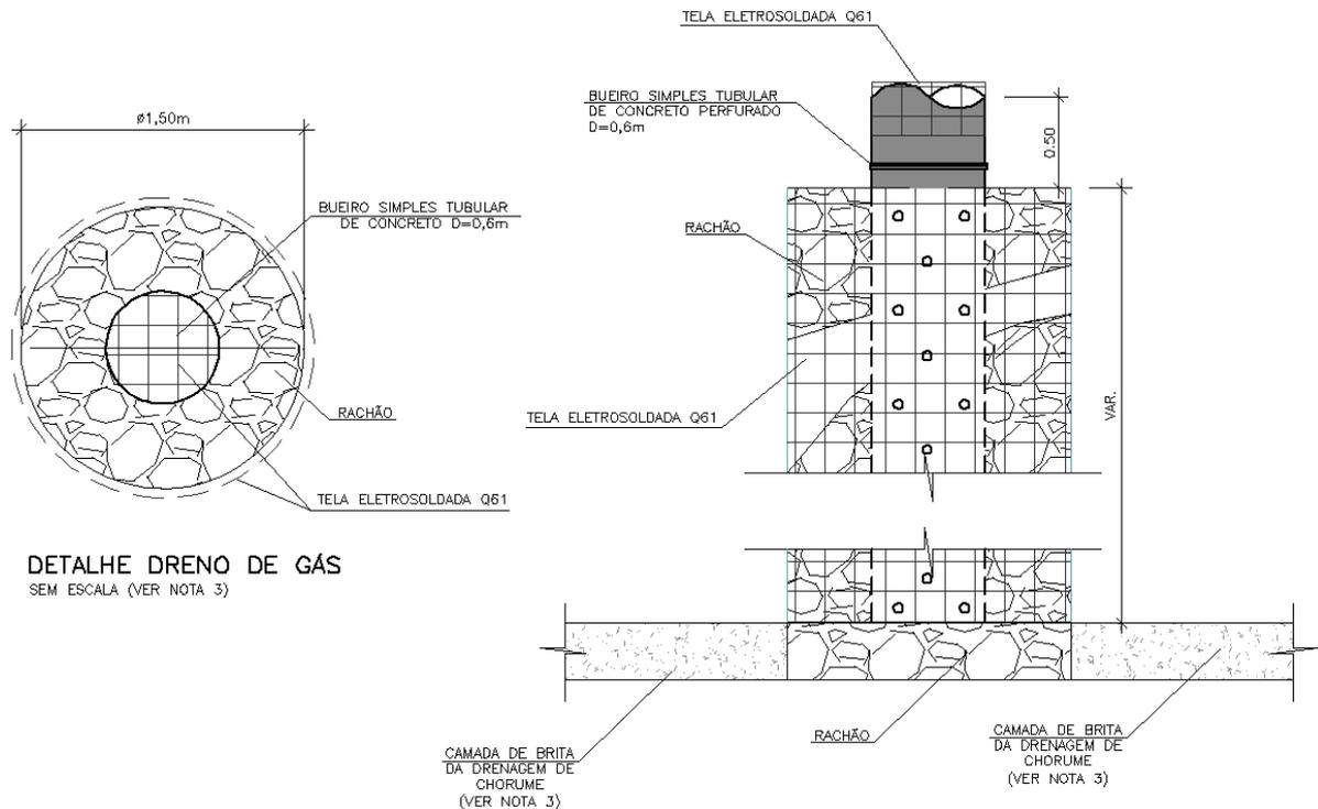
**Figura 5.10** - Detalhe dos drenos de gás.
