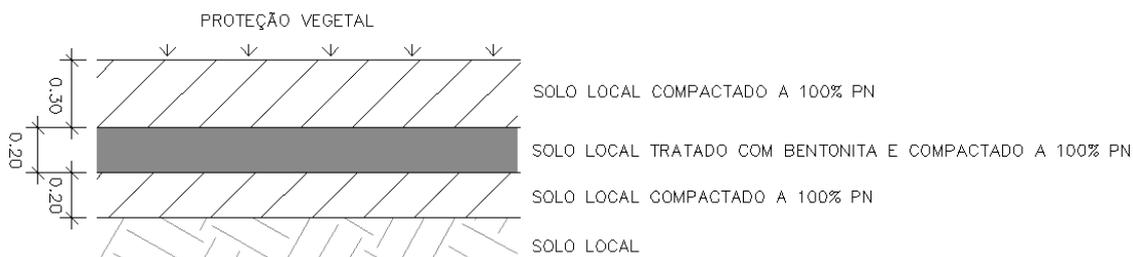
**Figura 5.9 - Detalhe das camadas do revestimento de fundo da lagoa de chorume.**
