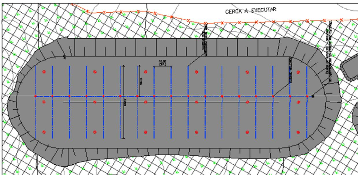
**Figura 5.7** - Disposição da tubulação do sistema de recirculação de chorume.
