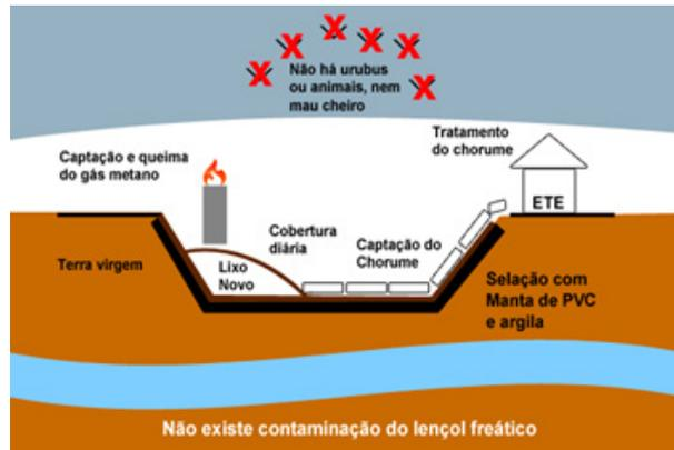
Figura 137: : Esquema do aterro sanitário.
