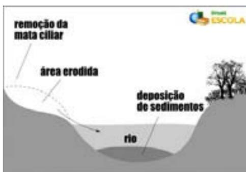
Figura 2.18. Esquema de uma área assoreada, com sedimentos sendo depositados no fundo do rio. Fonte: <http://brasilecola.uol.com.br/geografia/assoreamento-rios.htm>
